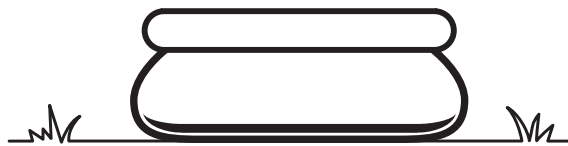
Suelo firme y nivelado - CORRECTO
