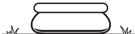
Sol ferme et à niveau – Correct
