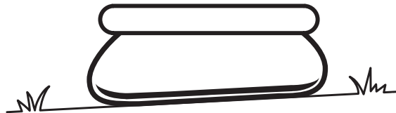
Suelo abultado, con pendiente - INCORRECTO
