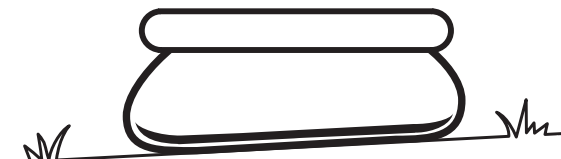
Sol bosselé et incliné – Incorrect
